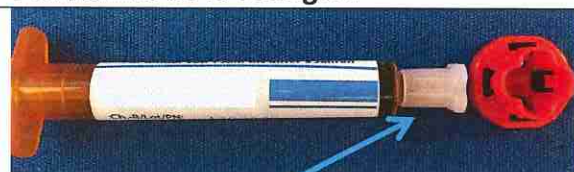
Figure 2. Retrait INCORRECT du capuchon : l'embout interne blanc reste fixé à l'extrémité de la seringue.
